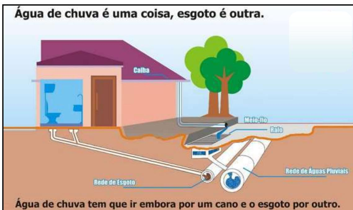
Figura 86 – Esboço do sistema de drenagem e esgoto
